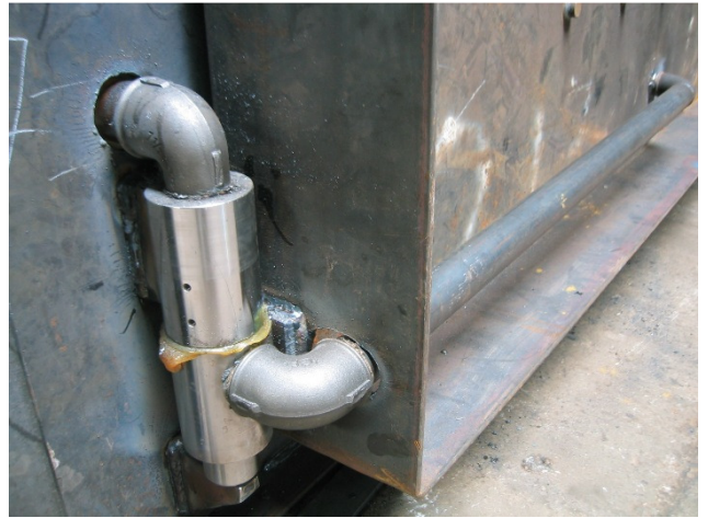
Vattenkyld lucka med vattenburna gångjärn
