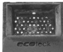
Förbränningskål i behov av rengörning där hålen är delvis täckta
