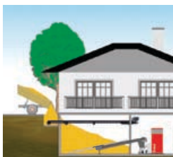
Flismatningssystem med fjädermatare i kombination med en flistransportör i taket. För optimal fyllning av förrådet.
