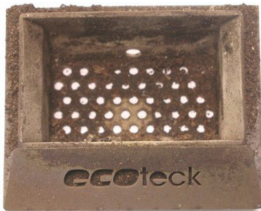
Förbränningskål i behov av rengöring där hålen är delvis täckta
