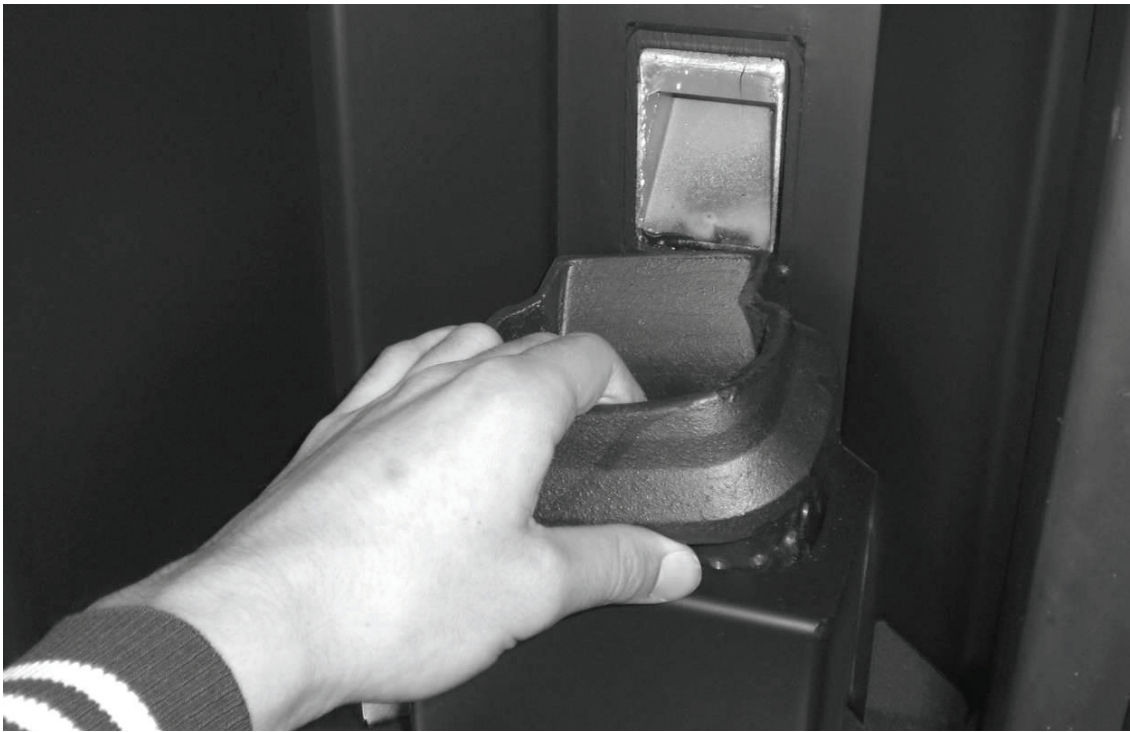
Nettoyer soigneusement le brasier des résidus de combustion en l'enlevant de son logement.
