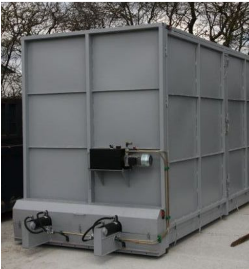
Kuva 4. Hydraulinen tankopurkainvarasto poikkiruuvilla
