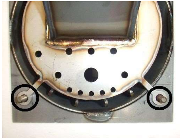
10. HUOM! Kun sisäinen polttoputki laitetaan takaisin paikalle, molemmat ohjaustapit on sovittava polttoputken reikiin.
