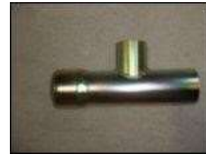
3. Näin muoviputki ja pääteputki yhdistetään.
