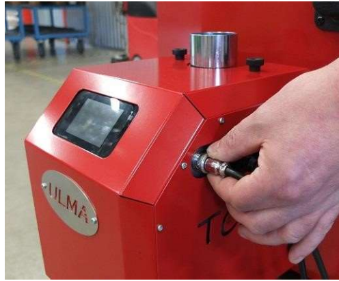
2. Kierrätä ensin lukkorengas auki, ennen kuin vedät lämpötila-anturin liitin ulos.
