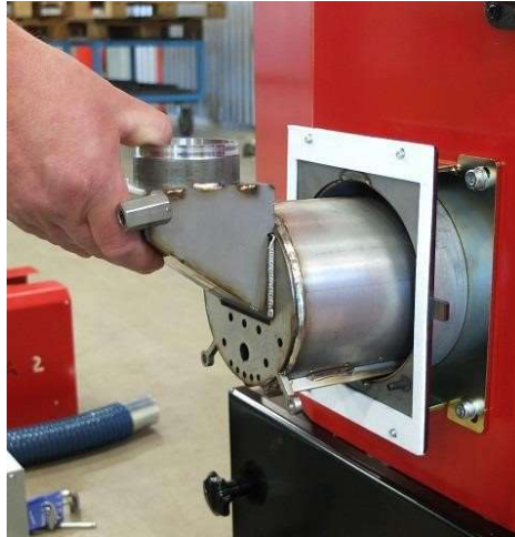
8. Vedä sisäinen pellettiputki ulos.
