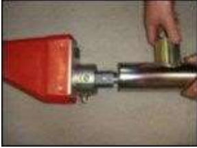
16. Työnnä ruuviputki kierukan yli
